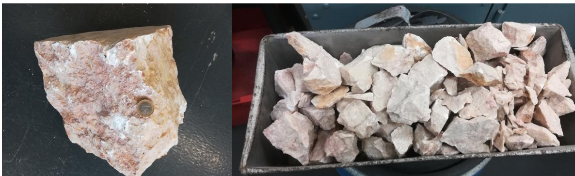
Figura 2 - À esquerda um bloco de Calcário de Lioz usado nos ensaios laboratoriais, à direita o mesmo bloco após fragmentação com recuso a marreta, num recipiente com 50 cm de comprimento e 20 cm de largura
