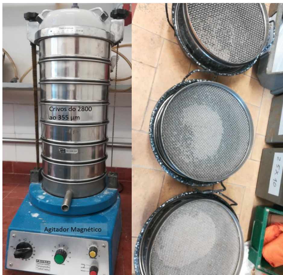
Figura 6 - Pilha de crivos sobre um agitador magnético (esquerda), e crivos virados sobre gamelas para recuperação do material supra crivo (direita) – Crivagem a seco
