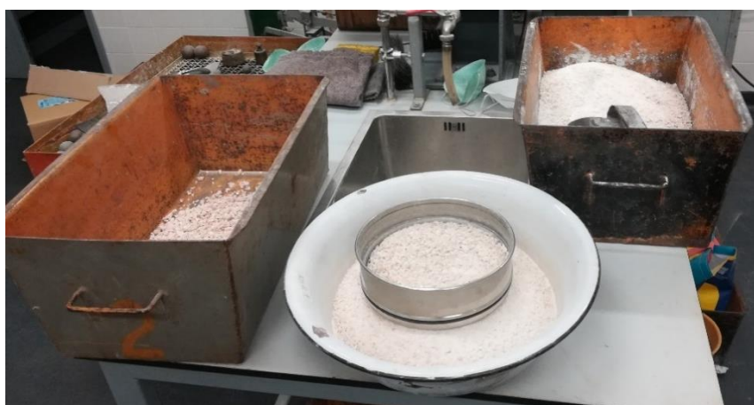
Figura 5 - Processo de crivagem manual do PMR
