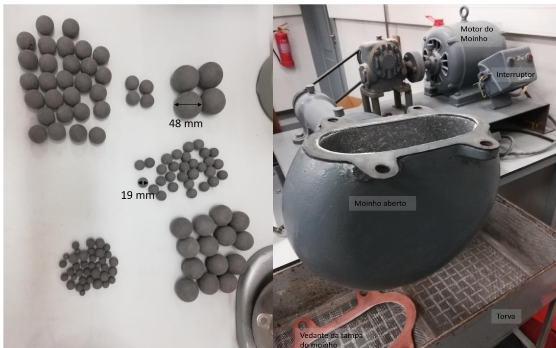
Figura 8 - Carga de bolas usada (esquerda) e um moinho de Denver aberto (direita)
